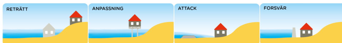
Figur 5. Åtgärdsstrategier för kustöversvämning
